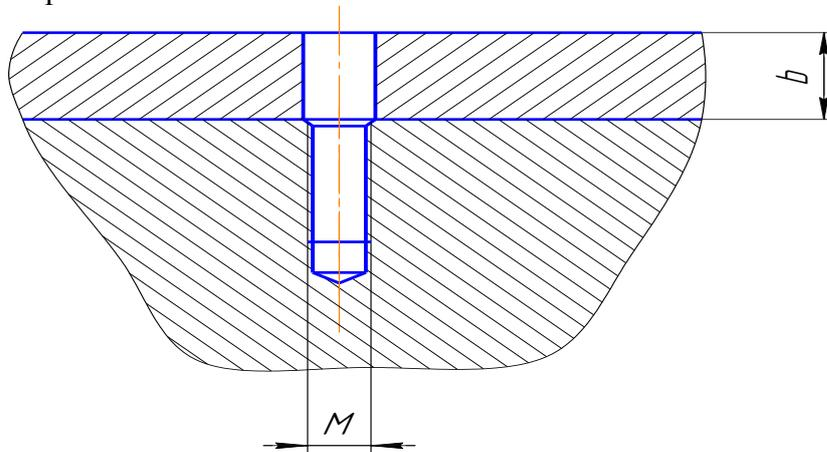
Лист №4. Начертить по 2 вида (спереди и сверху) полного и упрощенного изображения болтового соединения. Толщина пластины поз.1  $b = 5 + 2No$ , толщина пластины поз.2  $d = 10 + No$ . Диаметр болта  $M = 3 + No$ , где  $No$  – номер варианта.
