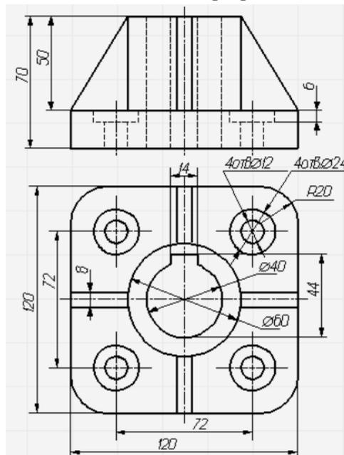
Лист №2. Построить прямоугольную изометрическую проекцию детали с вырезом четверти.
