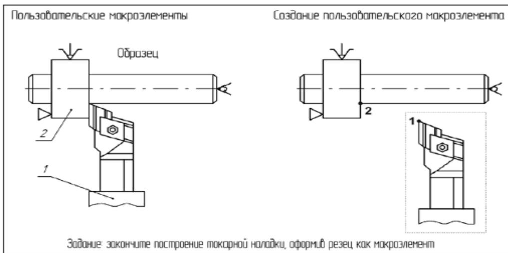
Изображение резца построено стандартными средствами системы. Оно состоит из отдельных геометрических примитивов. Чтобы убедиться в этом, можно щелкнуть по любому из элементов, входящих в резец. Будет выделен только указанный элемент. Чтобы продолжить выполнения упражнения, снимите выделение.
